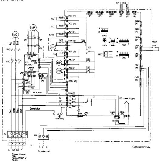
NOTE SW5-4 IS OFF IN CASE OF PUH-8YE. SW5-4 IS ON. IN CASE OF PUH-10YE.
