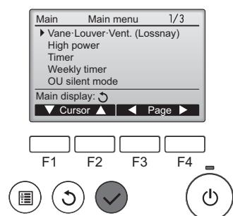
Main menu (Ana menüden) "Vane·Louver-Vent. (Lossnay)" (Kanat·Panjur·Havalandırma (Lossnay)) seçeneğini belirleyin (bkz. sayfa 117) ve [SEÇİM] düğmesine basın.
