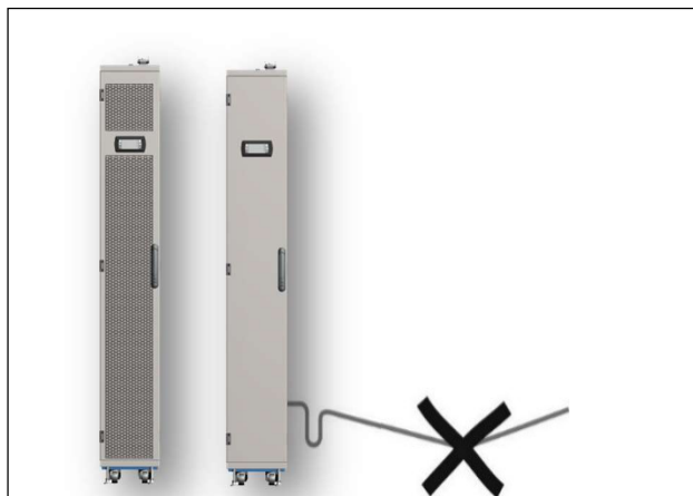
Rury połączeniowe muszą być odpowiednio podtrzymywane w taki sposób, aby nie obciążały maszyny swoim ciężarem.
