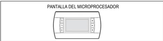
Microprocesador: gestiona el proceso de funcionamiento permitiendo configurar los parámetros y monitorear las condiciones operativas. Para los detalles del funcionamiento de la máquina y las interfaces, consulte el Manual de usuario
