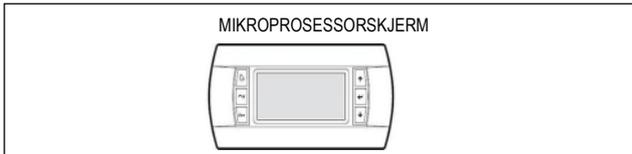
Mikroprosessor: styrer driftsprosessen, med mulighet for å sette parametere og overvåke driftsforhold.
