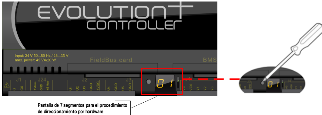
Figura 5-2: Direccionamiento tarjeta de control
