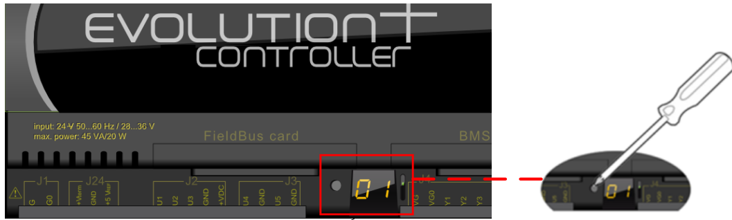
Οθόνη 7 τμημάτων για τη διαδικασία διευθυνασιοδότησης μέσω hardware
