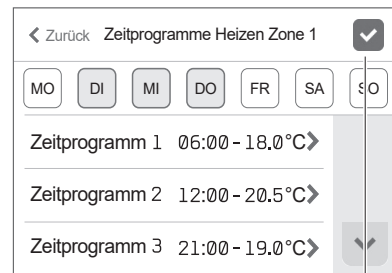
[Zeitprogramm Heizbetrieb Z1] Bearbeiten
