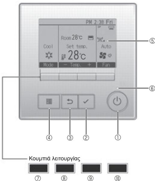
Οι λειτουργίες των κουμπιών λειτουργίας αλλάζουν ανάλογα με την οθόνη. Ανατρέξτε στον οδηγό λειτουργίας κουμπιών που εμφανίζεται στο κάτω μέρος της οθόνης LCD για τις λειτουργίες που εξυπηρετούν σε μια συγκεκριμένη οθόνη.
