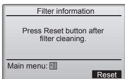
Nacisnąć przycisk [F4], aby zresetować symbol filtra. Sposób czyszczenia filtra można znaleźć w instrukcji obsługi jednostki wewnętrznej.
