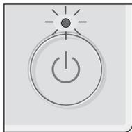
Presione el botón [ENCENDIDO/APAGADO]. La lámpara de ENCENDIDO/APAGADO se iluminará en verde y comenzará a funcionar la unidad. Cuando "LED lighting" (Iluminación LED) está ajustada en "No", la lámpara de ENCENDIDO/APAGADO no se encenderá.
