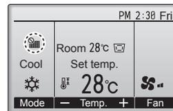
Wenn in der Hauptanzeige im „Komplett“ Modus ☐ erscheint, wird das System zentralgesteuert und das Filtersymbol kann nicht zurückgesetzt werden.
