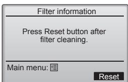
Tryk på [F4] -knappen for at nulstille filtersymbolet. Instruktionsbogen til indendørsenheden indeholder oplysninger om, hvordan filteret rengøres.
