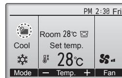
Quando ☰ appare nella schermata principale in modalità Completo, il sistema è controllato in maniera centrale e la segnalazione filtro non può essere ripristinata.
