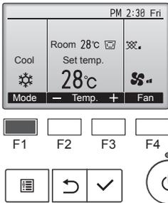
Drücken Sie [F1], um die Betriebsmodi in der Reihenfolge „Cool“ (Kühlen), „Dry“ (Trocken), „Fan“ (Lüfter), „Auto“ und „Heat“ (Heizen) zu durchlaufen. Wählen Sie den gewünschten Betriebsmodus aus.
