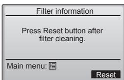
Appuyez sur la touche [F4] pour réinitialiser le témoin d'état du filtre. Reportez-vous au Mode d'emploi de l'appareil intérieur pour le nettoyage du filtre.
