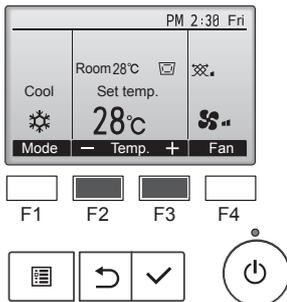
Tryk på [F2]-knappen for at reducere den forudindstillede temperatur, og tryk på [F3]-knappen for at øge den.
