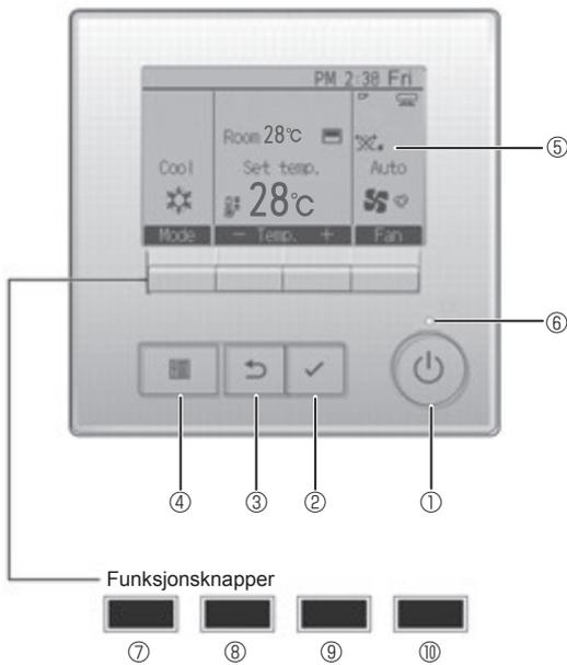
Funksjonene til funksjonsknappene skifter avhengig av skjermbildet. Se veiledningen for knappefunksjoner som står nederst på LCD-skjermen for å se hvilke funksjoner de har på et gitt skjermbilde. Når systemet er under sentralstyring, vises ikke veiledningen for knappefunksjonen til den låste knappen.
