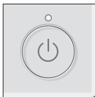
Premere di nuovo il pulsante [ON/OFF]. La luce ON/OFF si spegne e si arresta il funzionamento.
