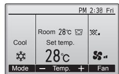
Appuyez sur la touche [F1] pour balayer les modes de fonctionnement parmi : "Cool" (Froid), "Dry" (Déshu.), "Fan" (Ventil.), "Auto", et "Heat" (Chaud). Sélectionnez le mode de fonctionnement désiré.
