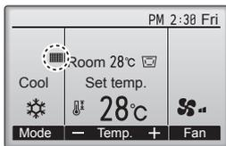
■ apparaît sur l'écran principal dans en mode complet quand les filtres doivent être nettoyés.
