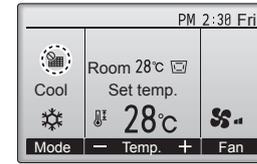
Ana ekranda Tam modda ■■■■■ görüntülediğinde, sistem merkezi olarak kontrol edilir ve filtre işareti sıfırlanamaz.
