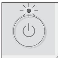
Tryk på [TÆND/SLUK]-knappen. TÆND-/SLUK-lampen lyser grønt, og anlægget starter. Når "LED-belysning" er indstillet til "Nej", lyser ON/OFF-lampen ikke.
