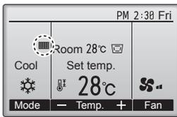
verschijnt in het Hoofddisplay in de stand Volledig wanneer het tijd is voor het reinigen van de filters.
