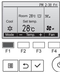
Druk op functietoets [F1] en doorloop de bedieningsstanden in de volgorde "Cool" (Koelen), "Dry" (Drogen), "Fan" (Ventilator), "Auto" en "Heat" (Verwarm). Selecteer de bedieningsstand van uw keuze.
