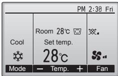
Prima o botão [F1] para percorrer os modos de funcionamento pela ordem "Cool" (Frio), "Dry" (Desum.), "Fan" (Vent), "Auto" e "Heat" (Calor). Seleccione o modo de funcionamento pretendido.
