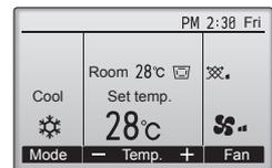
Presione el botón [F1] para ver los modos de operación en el orden de: "Cool" (Frío), "Dry" (Secar), "Fan" (Vent.), "Auto" y "Heat" (Calor). Seleccione el modo de funcionamiento deseado.
