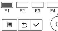
Trykk på [F1]-knappen for å gå gjennom driftsmodusene i rekkefølgen "COOL" (Avkjøling), "Dry" (Tøking), "Fan" (Vifte), "Auto" og "Heat" (Oppvarming). Velg ønsket driftsmodus.
