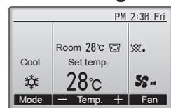
Tryck på knappen [F1] för att gå igenom driftlägen i ordningen "Cool" (Kyla), "Dry" (Torr), "Fan" (Fläkt), "Auto" och "Heat" (Värme). Välj önskat driftläge.
