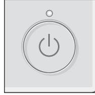
[AÇMA/KAPATMA] düğmesine tekrar basın. AÇMA/KAPATMA lambası söner ve çalışma durur.
