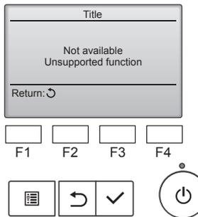
Le message à gauche s'affiche si l'utilisateur sélectionne une fonction non prise en charge par le modèle d'appareil intérieur considéré.
