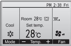
Çalışma modları arasında "Cool" (Soğutma), "Dry" (Kurutma), "Fan", "Auto" (Otomatik) ve "Heat" (Isıtma). sırasıyla gezinmek için [F1] düğmesine basın. İsteddiğiniz çalışma modunu seçin.
