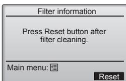
Drücken Sie [F4], um das Filtersymbol zurück zu setzen. Einzelheiten zur Reinigung des Filters finden Sie im Bedienungshandbuch des Innengeräts.
