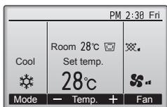
Tryk på [F1]-knappen for at se funktionsmåderne i rækkefølgen "Cool" (kulde), "Dry" (tør), "Fan" (ventilator), "Auto" og "Heat" (varme). Vælg den ønskede funktionsmåde.
