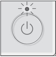
Trykk på [PÅ/AV]-knappen. PÅ/AV-lampen lyser grønt og driften starter. Når "LED-belysning" er stilt til Ingen, tennes ikke PÅ/AV-lampen.
