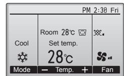
Πιέστε το κουμπί [F1] για να περάσετε από όλες τις καταστάσεις λειτουργίας με τη σειρά "Cool" (Ψύξη), "Dry" (Αφύγρανση), "Fan" (Ανεμιστήρας), "Auto" (Αυτόματο), και "Heat" (Θέρμανση). Επιλέξτε την επιθυμητή κατάσταση λειτουργίας.
