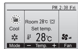
Når der vises ☰ på hoveddisplay i funktionen komplet, er systemet centralt styret, og filtersymbolet kan ikke nulstilles.
